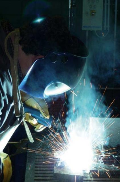
**Bild 1** aufsteigender Schweißrauch ohne Absaugung
