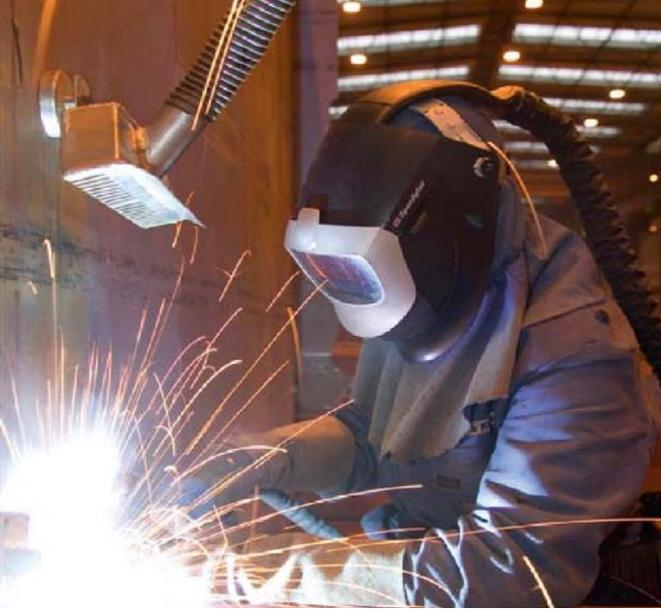
**Bild 8** Schweißrauchabsaugung plus Schweißerschutzhaube mit Frischluftversorgung (persönliche Schutzausrüstung)
