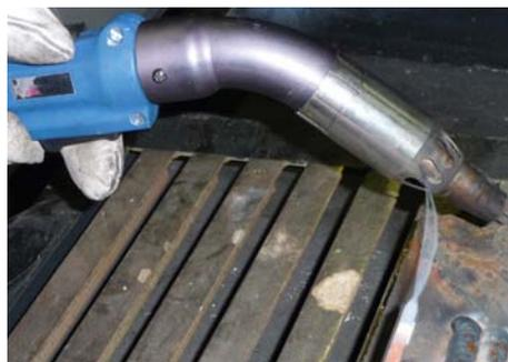
**Bilder 2 + 3** brennerintegrierte Absaugung
