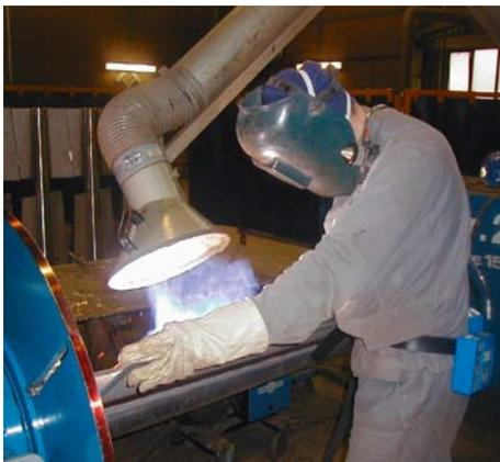
**Bild 4** Absaugarm mit Erfassungselement
