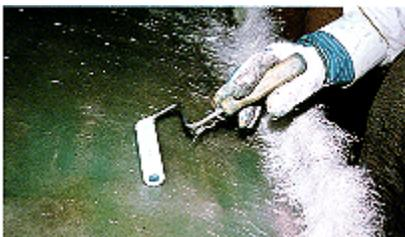
Beim **Faserspritzen** werden Fasern in einer Spritzpistole gehäckselt, mit Harz vermischt und in dieser Zusammensetzung auf eine Form aufgespritzt.
