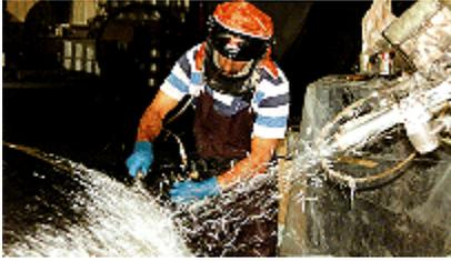
Beim **Wickeln** werden Fasern und Harz maschinell auf eine rotierende Form aufgebracht.
