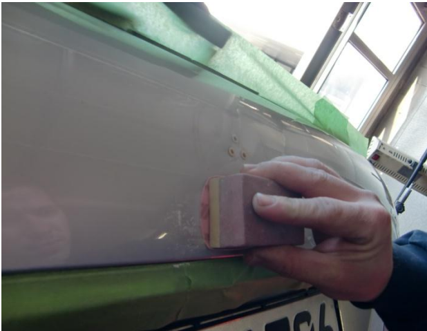
Bild 1: Anschleifen der Schadstelle
